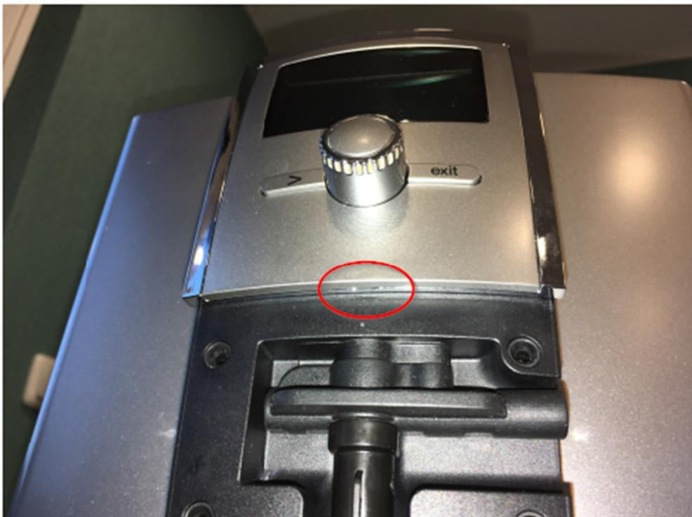
... hier kann man dann mit einem Schraubendreher die Abdeckung aushebeln
