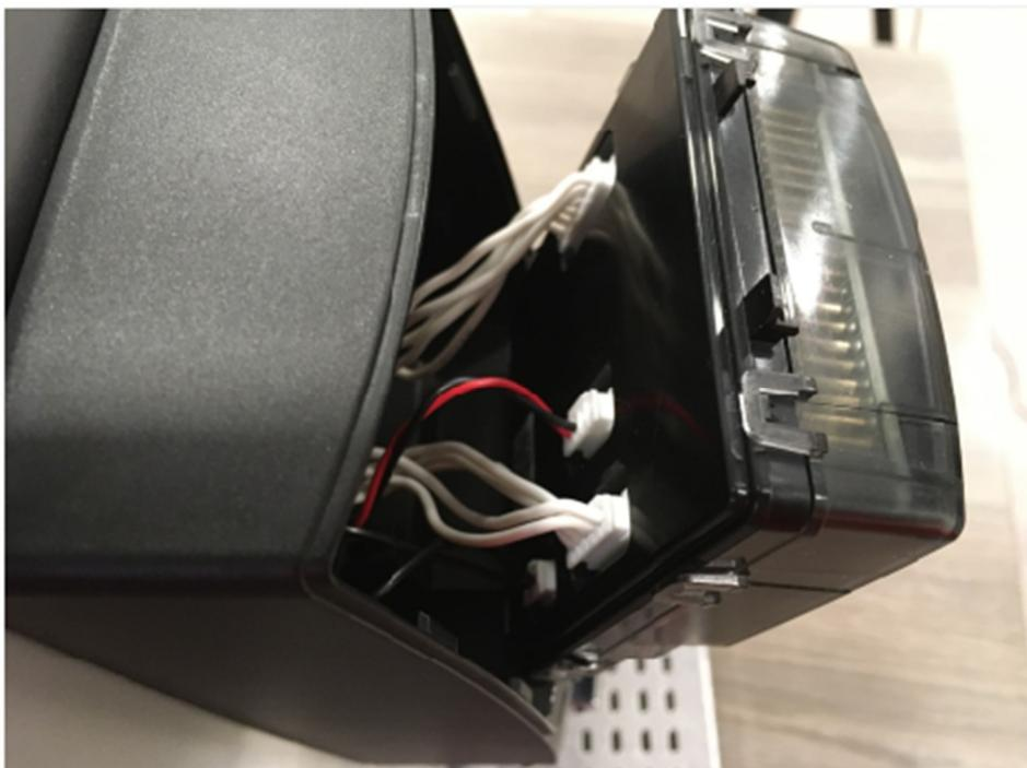
**Die Stecker können nicht vertauscht werden. Anschließend erfolgt der Einbau in umgekehrter Reihenfolge.**
