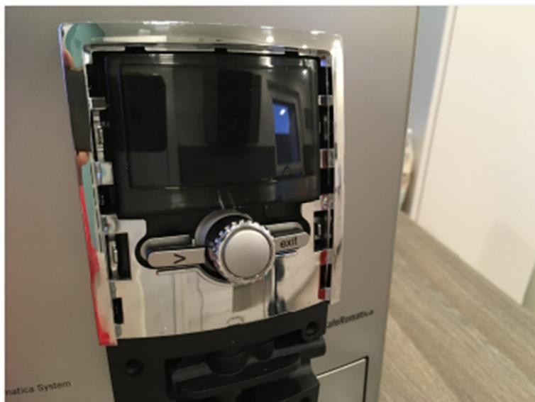
**Als nächstes müssen die beiden Taster und der Drehknopf abgezogen werden. Der Drehknopf geht manchmal schwer abzuziehen.**
